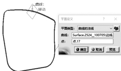
图 3 经过点与线垂直的平面作为断面草绘平面
